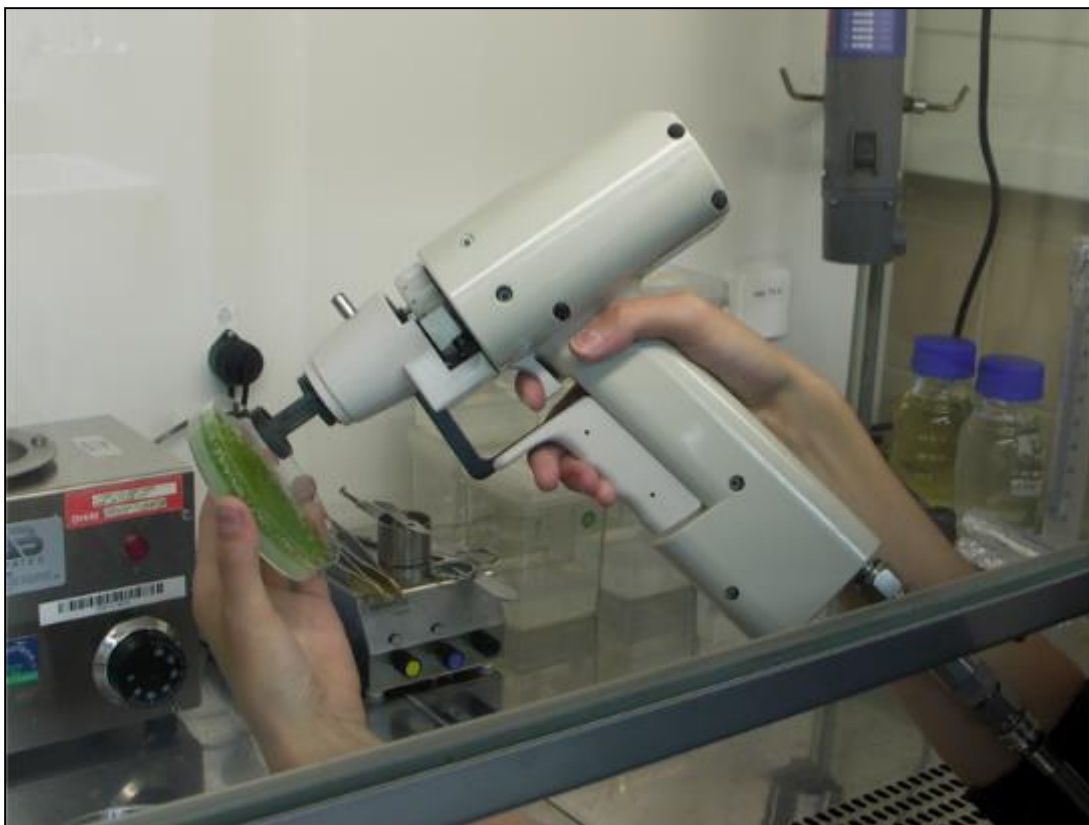
Obr. 2.: Nastřelování tkáně mechu P. patens pomocí BioRad systému „Helios Gene Gun“
